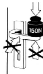
Kliku lze namáhat pouze v normálním směru otáčení. Ve směru otáčení je možno působit rovněž silou pouze maximálně 150 N.
