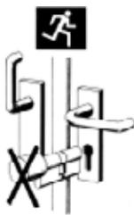
Upozornění: Při použití tyčové rukojeti nesmí dojít ke vzpříčení v důsledku namontování cylindrické vložky zámku s rukojetí nebo otočným knoflíkem.
