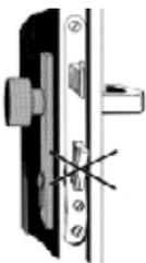
Jsou-li viditelné stopy násilného použití, je nutné zámek vyměnit.
