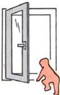
U oken, kde chcete zamezit přístup dětem, můžeme zajistit křídla proti otevření např. pojistkou proti otevření nebo zamykatelnou klikou
